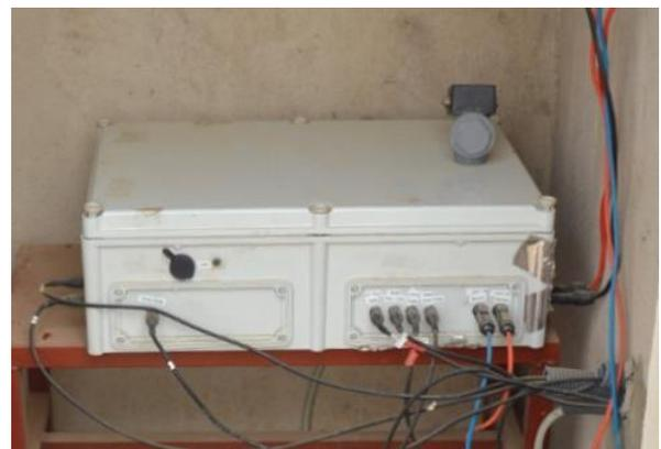
figure 8 – Système de collecte de données développé pour le monitoring du PVWPS de Gogma
